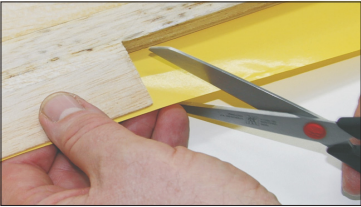
(12a) innere Ecken mit 45° einschneiden
