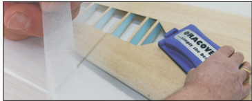
(2) Struktur Oberfläche glatt verschleifen
