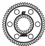
UT008 (B) x1 Spur Gear 57T スパーギヤ 57T
