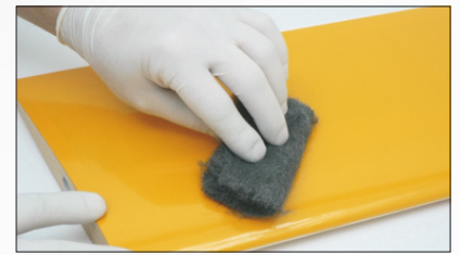
ORACOVER® kann mit „000“ Stahlwolle aufgeraut werden. VOR dem Aufrauen mit Entfetter (Nr. 08245) reinigen.
